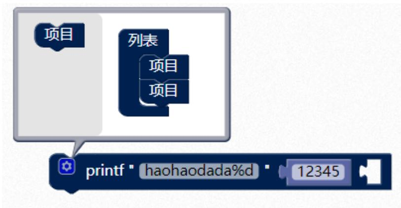
如果要输出多个参数，可以点击蓝色齿轮，然后把左边的项目拖到列表里，就能多一个输入框，自己再拖入一个数字模块。
