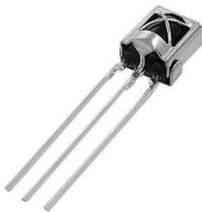
内置专用 IC，自动过滤 38KHz 载波，输出红外信号。
