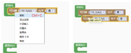
3. 复制多个块，鼠标左键选中多个块的第一个块，拖动多个块移动的时候，按“Ctrl+C”，松开鼠标左键，按“Ctrl+V”粘贴块。
