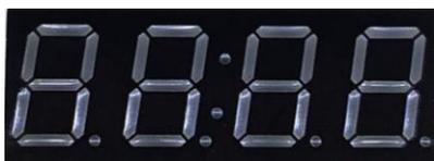
共阳数码管是指将所有发光二极管的阳极接到一起，形成公共阳极（COM）的数码管，共阳数码管在应用的时候，应该将 COM 端口接到正极，当某一段发光二极管的阴极为低电平的时候，相对应的段就点亮，当某一段的阴极为高电平的时候，相对应段就不亮。
