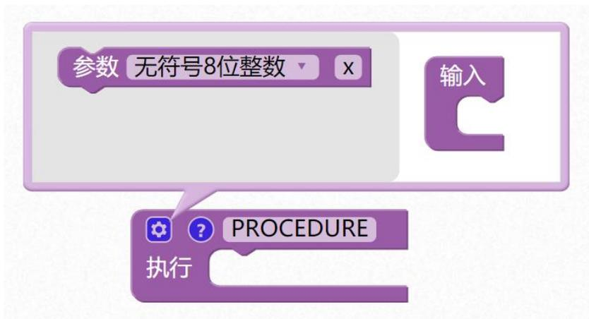
函数块使用好了后，在函数栏目里会自动出现对应的执行函数块。
