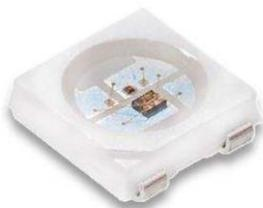
WS2812 是一个集控制电路与发光电路于一体的智能外控 LED 光源。其外型与一个 5050LED 灯珠相同，每个元件即为一个像素点。像素点内部包含了智能数字接口数据锁存信号整形放大驱动电路，还包含有高精度的内部 振荡器和可编程定电流控制部分，有效保证了像素点光的颜色高度一致。数据协议采用单线归零码的通讯方式，像素点在上电复位以后，DIN 端接受从控制器传输过来的数据，首先送过来的 24bit 数据被第一个像素点提取后，送到像素点内部的数据锁存器，剩余的数据经过内部整形处理电路整形放大后通过 DO 端口开始转发输出给下一个级联的像素点，每经过一个像素点的传输，信号减少 24bit。像素点 采用自动整形转发技术，使得该像素点的级联个数不受信号传送的限制，仅受限信号传输速度要求。
