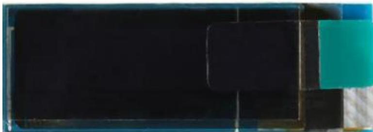
OLED，即有机发光二极管（Organic Light-Emitting Diode），又称为有机电激光显示（Organic Electroluminescence Display, OLED）。OLED 同时具备自发光，不需背光源、对比度高、厚度薄、视角广、反应速度快、可用于挠曲性面板、使用温度范围广、构造及制程较简单等优异之特性。模块具有一下特点：
