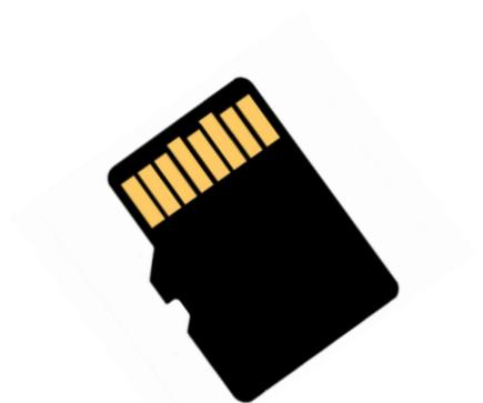
SD 存储卡( Secure Digital Memory Card)是一种基于半导体快闪存储器的新一代高速存储设备。SD 存储卡的技术是从 MMC 卡( MultiMedia Card 格式上发展而来，在兼容 SD 存储卡基础上发展了 SDIO( SD Input/ Output)卡，此兼容性包括机械，电子，电力，信号和软件，通常将 SD、SDIO 卡俗称 SD 存储卡。
