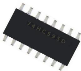
74HC595 是一个 8 位串行输入、并行输出的位移寄存器：并行输出为三态输出。在 SCK 的上升沿，串行数据由 SDL 输入到内部的 8 位位移寄存器，并由 Q7' 输出，而并行输出则是在 LCK 的上升沿将在 8 位位移寄存器的数据存入到 8 位并行输出寄存器。当串行数据输入端 OE 的控制信号为低使能时，并行输出端的输出值等于并行输出寄存器所存储的值。
