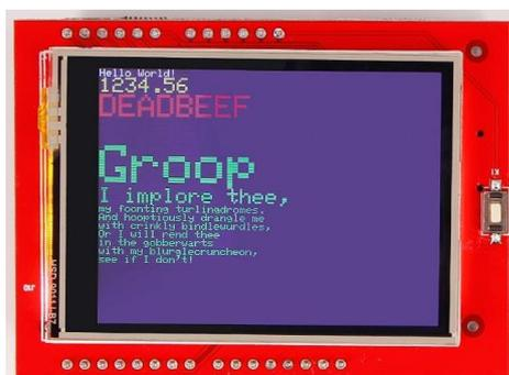
TFT (Thin Film Transistor) 即薄膜场效应晶体管，它可以“主动地”对屏幕上的各个独立的像素进行控制，这样可以大大提高反应时间。一般 TFT 的反应时间比较快，约 80 毫秒，而且可视角度大，一般可达到 130 度左右，主要运用在高端产品。从而可以做到高速度、高亮度、高对比度显示屏幕信息。TFT 属于有源矩阵液晶显示器，在技术上采用了“主动式矩阵”的方式来驱动，方法是利用薄膜技术所作成的电晶体电极，利用扫描的方法“主动拉”控制任意一个显示点的开与关，光源照射时先通过下偏光板向上透出，借助液晶分子传导光线，通过遮光和透光来达到显示的目的。
